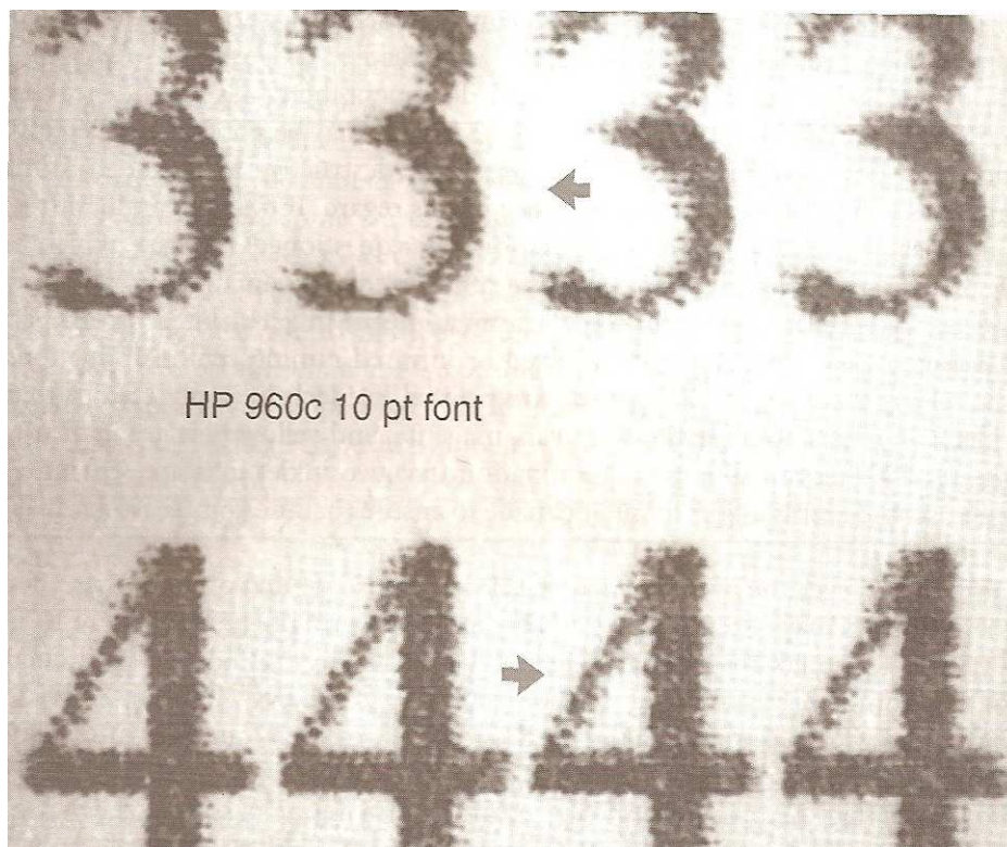
Fig. 16.1: Immagine ravvicinata della configurazione dell'inchiostro in una stampante a getto d'inchiostro. La fotomicrografia illustra come l'eccesso si sia depositato in direzioni diverse nelle due righe di numeri.
